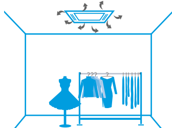
Rozkład powietrza z zabrudzonym filtrem
