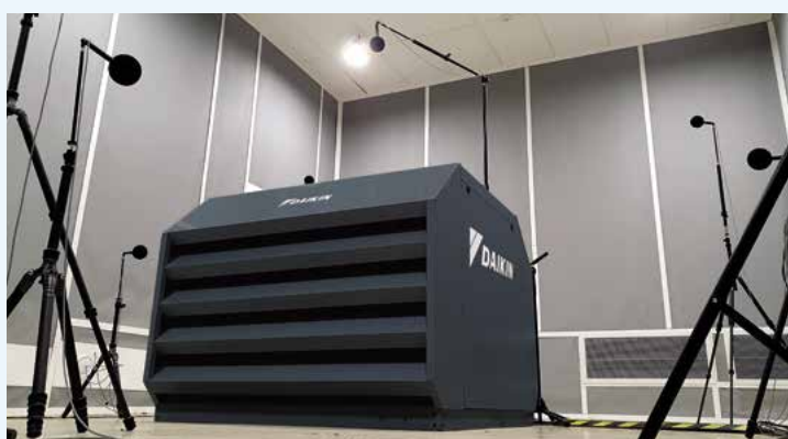
Pomiar poziomu mocy akustycznej w komorze akustycznej
